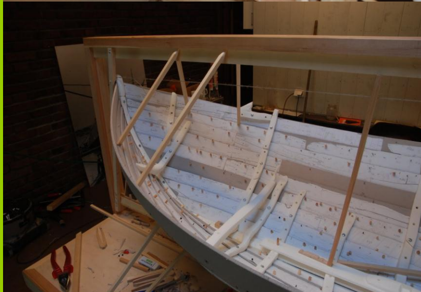
Bildeserie 2: Modellarbeidet består i å velge. Lars øver svakt press på tredje borgang for å se hvordan det påvirker legget og strekket på bordet ovenfor. I akterkant ser vi hvordan speilet tar form. Modellen ble målt opp av Andreas Kerr og Sarah Fawsith fra Dokulaben. På utskriften av oppmålingen er innveden utelatt men kjølsvinet ligger igjen. Tegningen av to botnband, X060 og X021, viser fire tilstander: 1) Den flateste varianten er rekonstruksjon ut fra kjøflia og brunfellingene, over denne kommer 2) in-situ dokumentasjonen. Deretter kommer 3) et snitt fra modellen. Selve 4) bandene er her gjengitt som solidere basert på 3D oppmålingen på Dokulaben. (Bare en foreløpig illustrasjon av 1 og 4). Foto: NMM og BåtLab'en. Illustrasjoner: Dokulaben.
